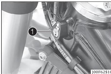
Замок блокировки рулевой колонки **1** установлен в левой части рулевой колонки. Замок блокировки рулевой колонки используется для блокировки рулевого управления. При этом дальнейшее рулевое управление – и, соответственно, движение – невозможно.
