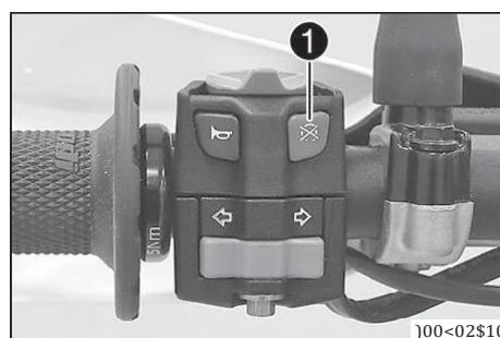
Выключатель отсечки топлива **1** расположен на левой рукоятке руля.
