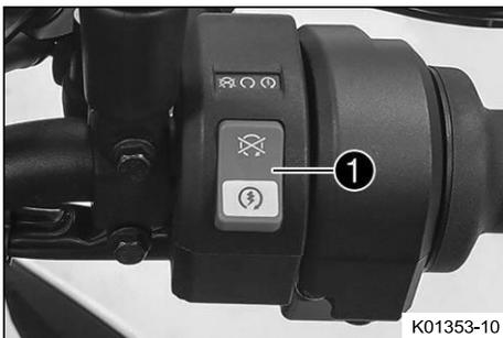
Кнопка пуска/аварийный выключатель 1 установлен на правой стороне комбинационного переключателя.
