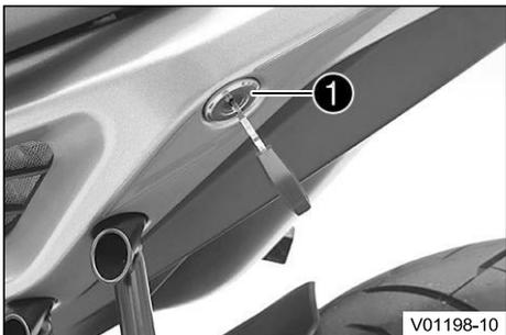
Замок сиденья **1** расположен с левой стороны транспортного средства. Его можно заблокировать с помощью ключа зажигания.
