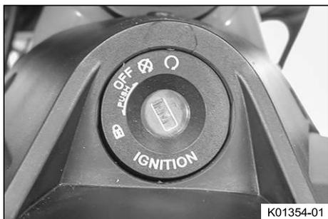
Замок зажигания и рулевой колонки расположен перед верхней траверсой.
