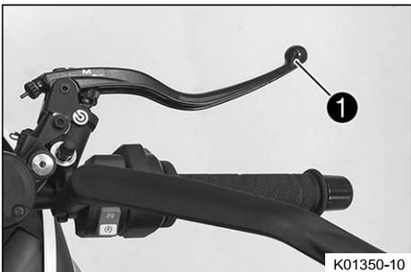
Рычаг ручного тормоза ❶ расположен на правой стороне руля. Передний тормоз включается с помощью рычага переднего тормоза.
