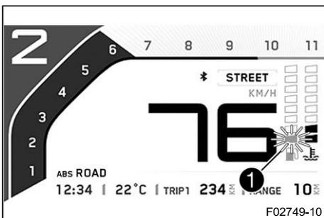
Индикатор уровня топлива **1** состоит из полосок. Чем больше полосок светится, тем больше топлива находится в топливном баке.
