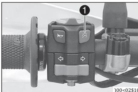
Выключатель отсечки топлива **1** расположен на левой рукоятке руля. **Возможные состояния**
